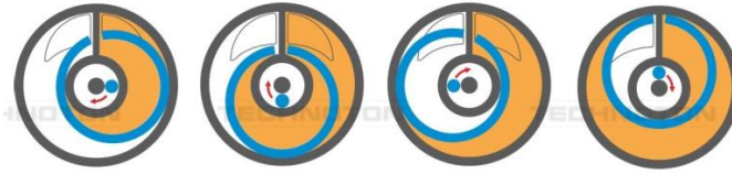
Figura 1. Esquema de funcionamiento de la cámara de medición DFM.
