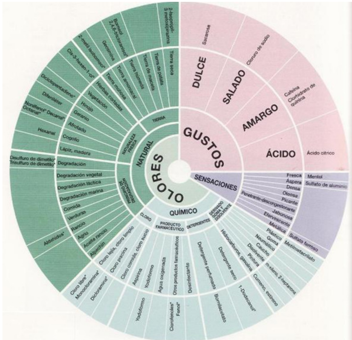
Ilustración 1. Rueda empleada por la American Water Works Association que representa los gustos, olores y sensaciones más importante
