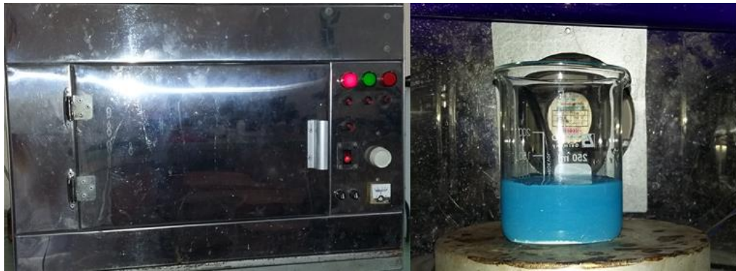
Figura 10. Reactor utilizado en la degradación de azul de metileno.
