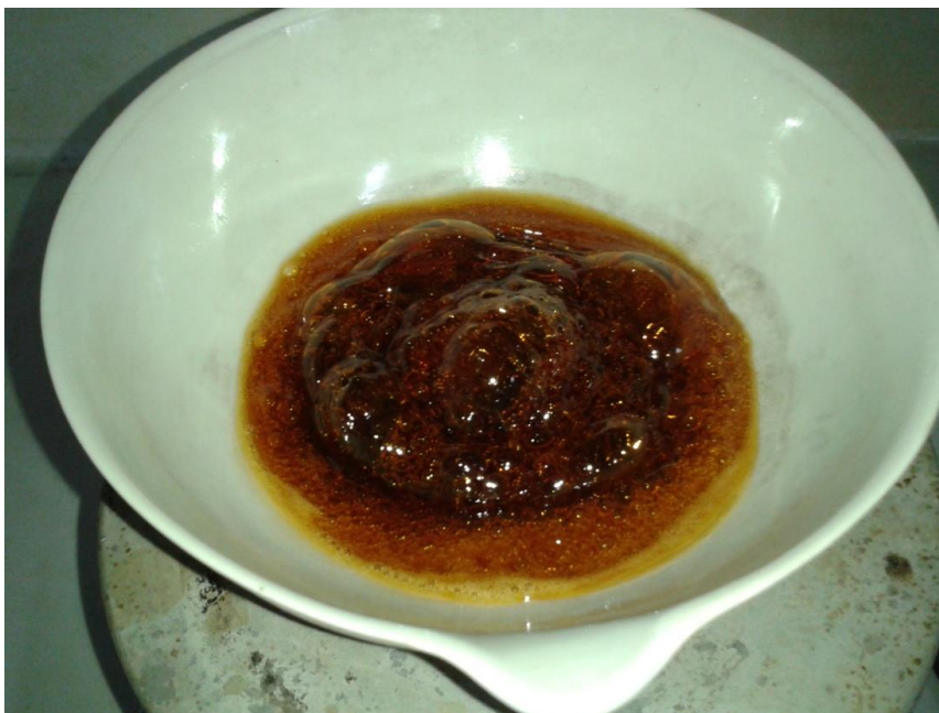
Figura 8. Formación de gel utilizando el método del complejo polimerizable (PC) o método Pechini.
