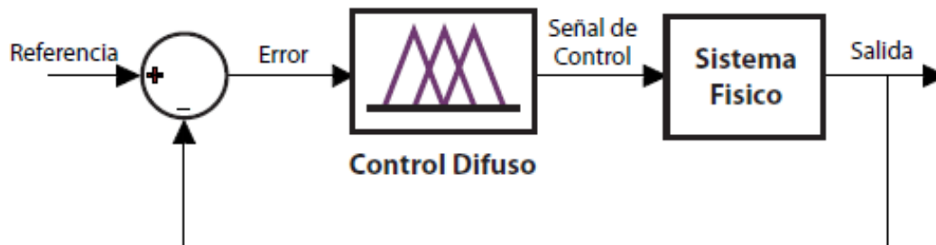
Figura 2.8 Sistema de control difuso en lazo cerrado.
