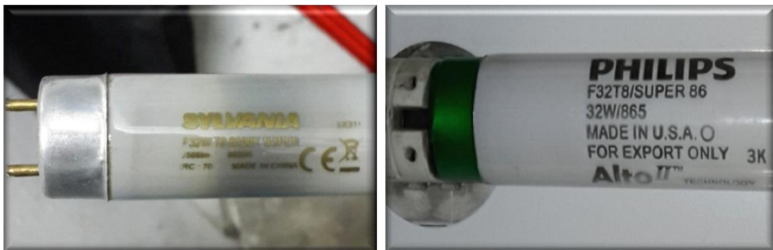
Figura 7 Marcación de los tubos.
