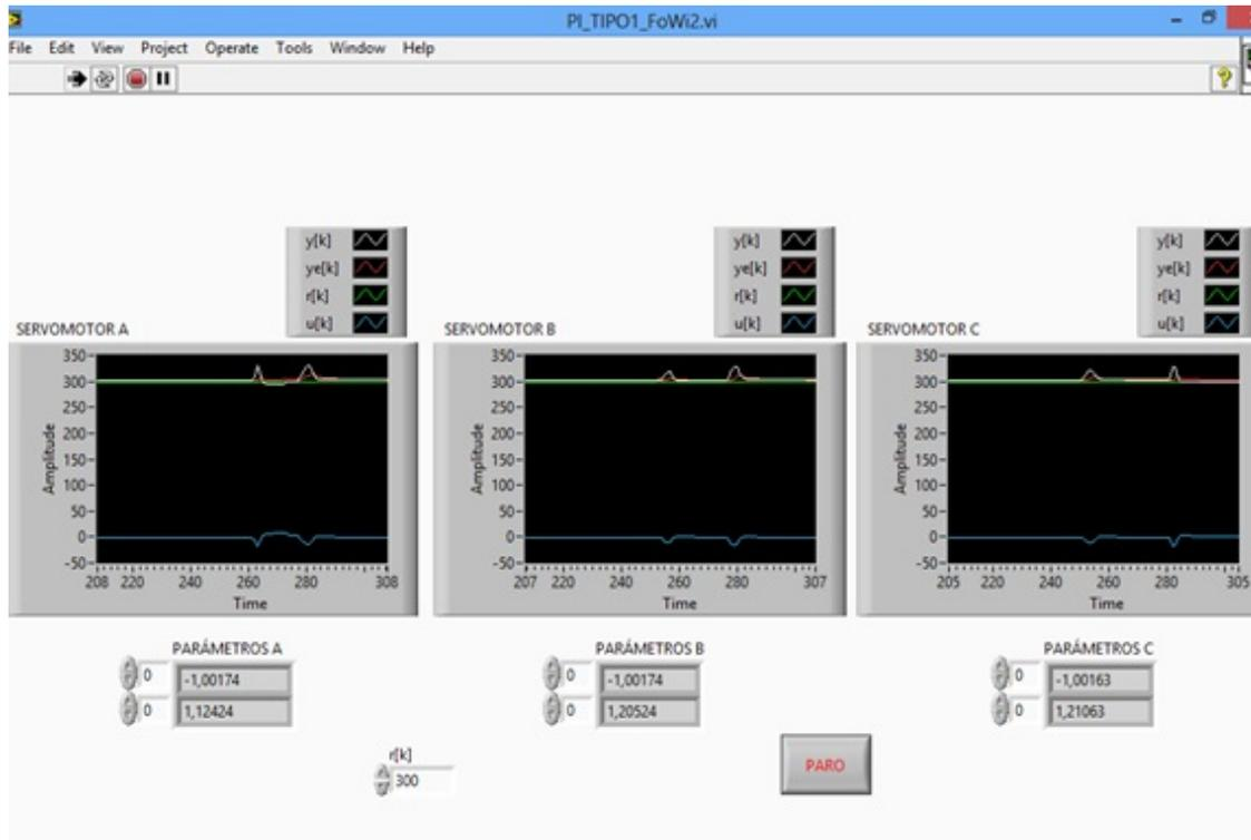
Figura 4.7: Perturbación Control PI con “anti-windup”.
