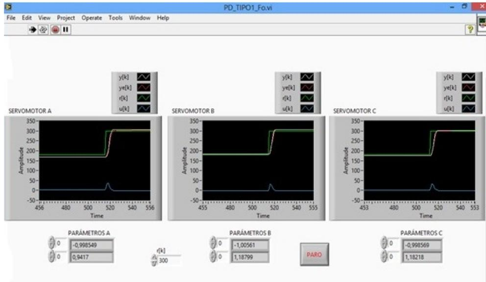
Figura 4.2: Respuesta del control PD a partir de un polinomio deseado con polos en 0.3 y 0.6
