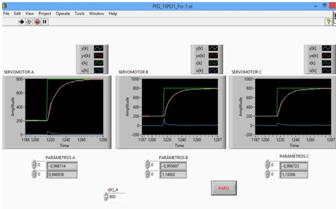
Figura 4.8: Control PID Tipo I, con los polos del polinomio deseado fijados en 0.8,0 y 0.9
