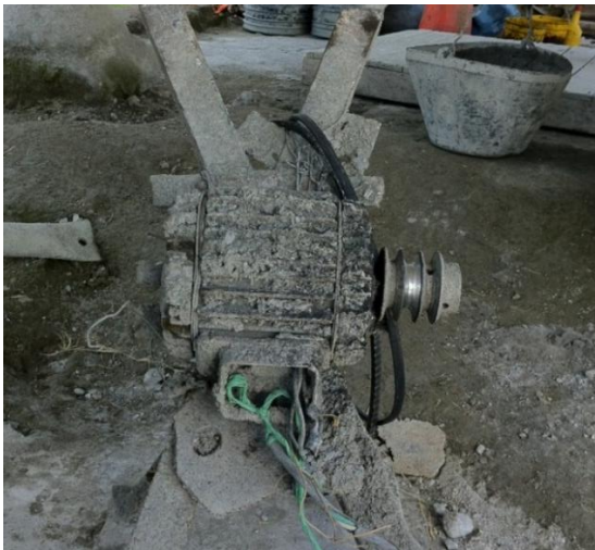
Figura 21. Motor vibrador de concreto
