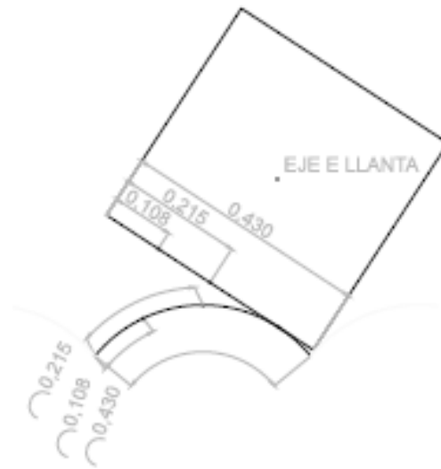
Figura 7. Relación entre pista y llanta (medidas reales)
