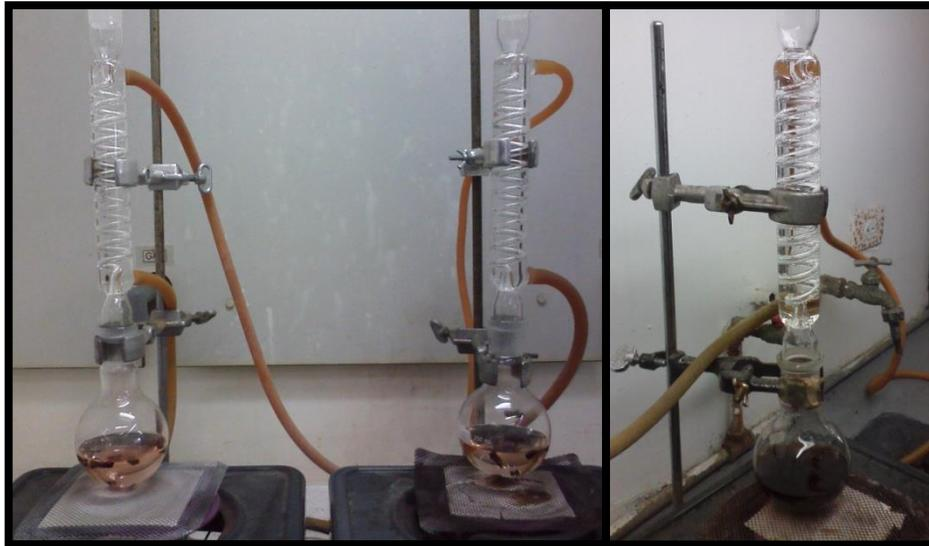
Ilustración 8. Digestión ácida y básica para determinar fibra.
