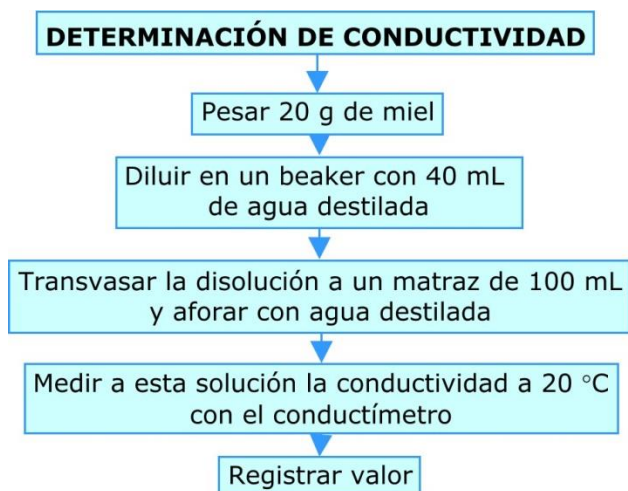
Figura 16. Procedimiento para la determinación de la conductividad en una muestra de miel de abejas (Navarrete, 2013).
