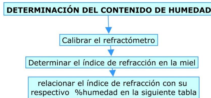
Figura 14. Procedimiento para determinar el contenido de humedad en miel de abejas (Navarrete, 2013) .
