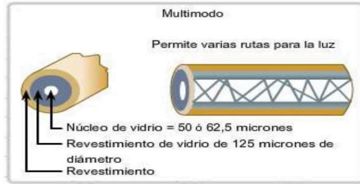
Figura 19. Fibra óptica multimodo.
