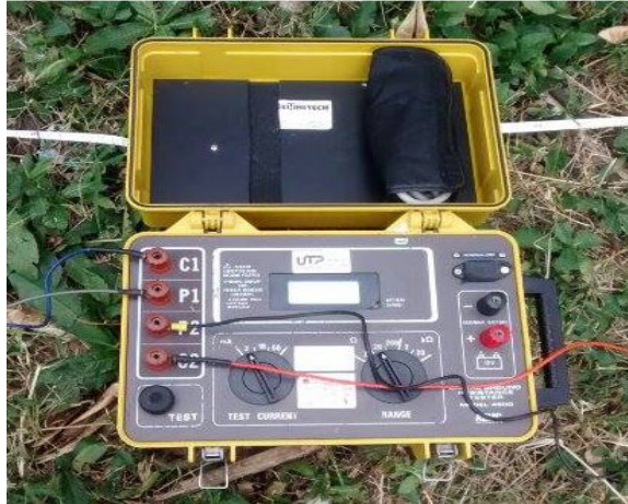
Figura 52. Medida de resistividad del terreno con telurómetro.
