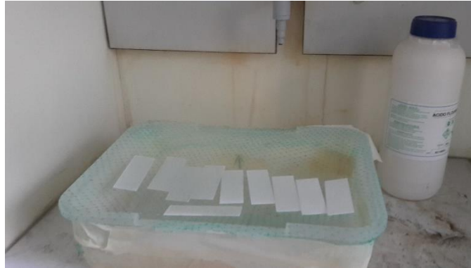
Figura 4. Montaje para el tratamiento con Ácido Fluorhídrico
