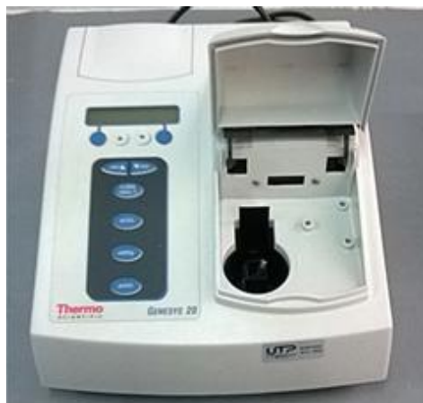
Ilustración 23. Espectrofotómetro UV-Vis marca Génesis, modelo UV 20
