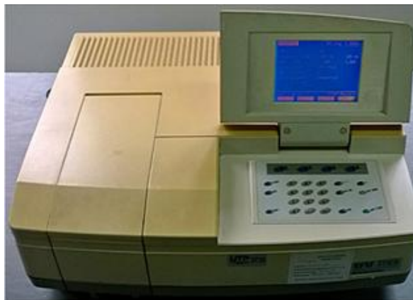
Ilustración 22. Espectrofotómetro UV-Vis marca Shimadzu, modelo UV 1700
