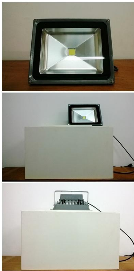
Ilustración 21. Reactor fotocatalítico construido y la lámpara utilizada en la reacción de degradación del azul de metileno y verde de malaquita.
