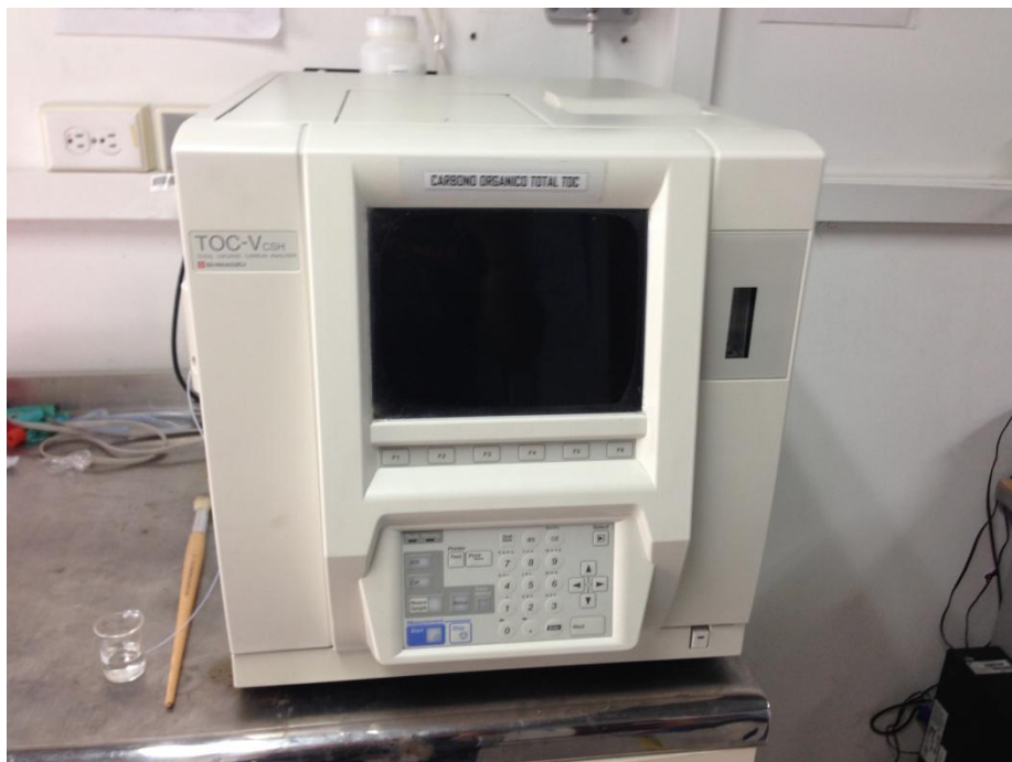
Ilustración 24. Analizador de Carbono Orgánico total TOC, marca Shimadzu, modelo Vcsh
