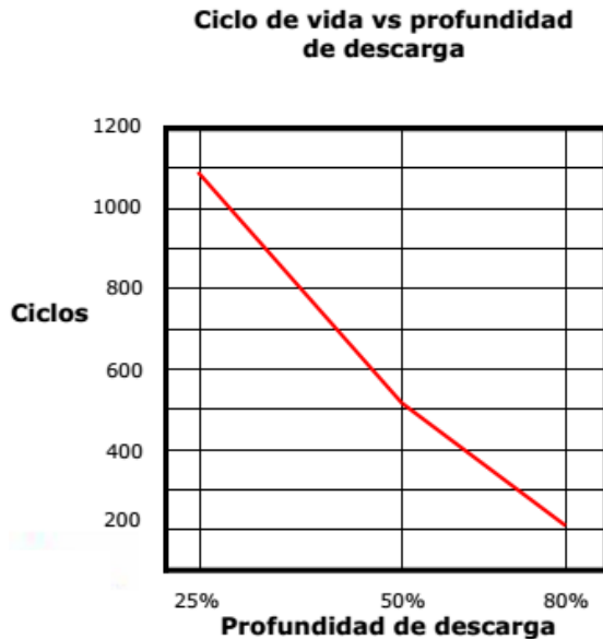
Figura 38. Ciclo de vida vs profundidad de descarga en baterías
