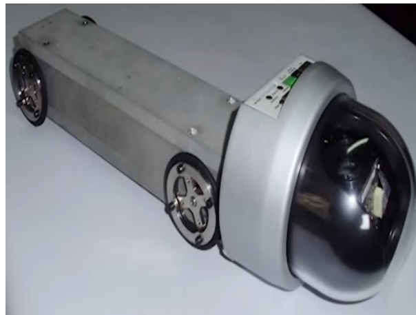
Figura 4.13: Prototipo del Robot para la Inspección de Alcantarillados [35]
