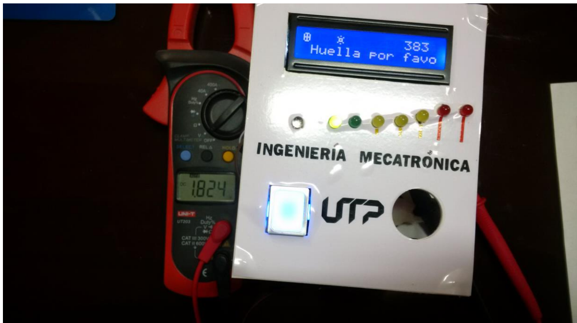
Figura 15. Valor obtenido con una muestra impregnada de Cerveza con 4 % de alcohol.
