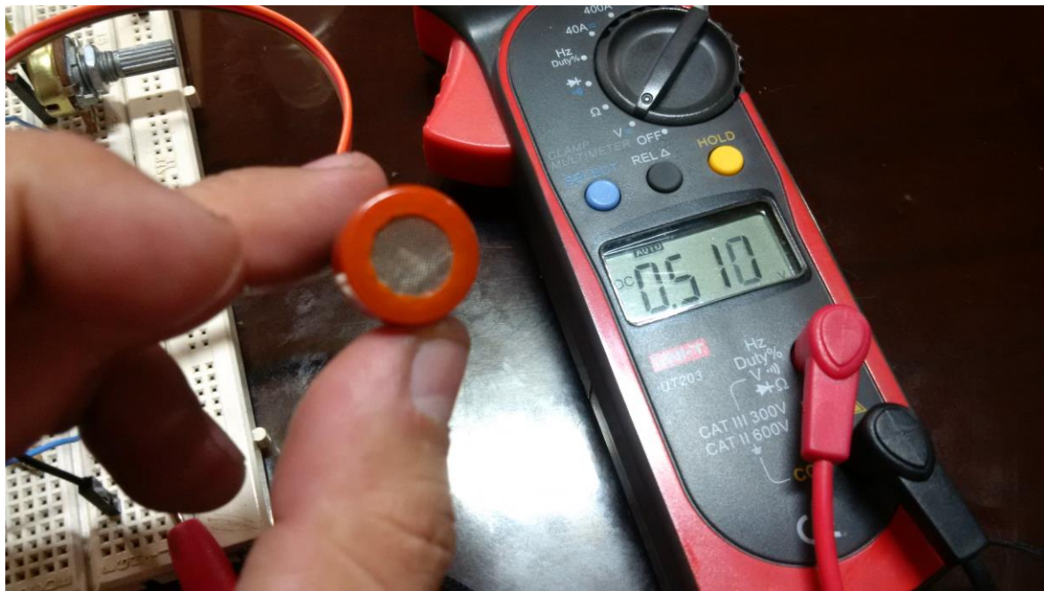
Figura 9. . Prueba de calibración con sensor MQ-3 si estabilizador.
