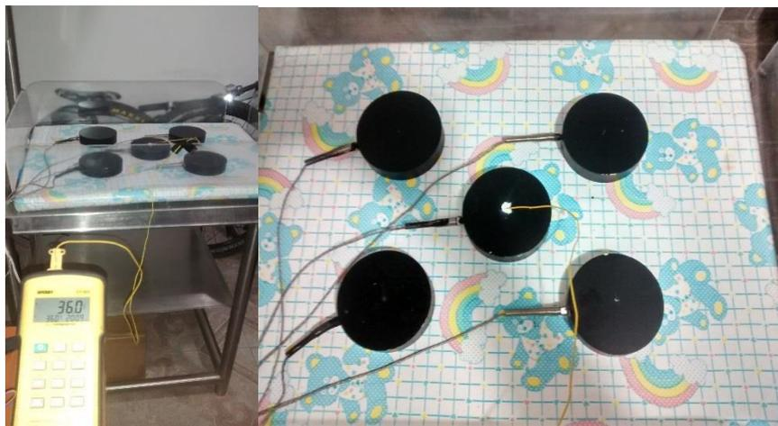
Finalmente se verifica la precisión de los datos con respecto al patrón; Claramente se observa buen seguimiento al valor de referencia  $36.0\text{ }^{\circ}\text{C}$ , además de una excelente aproximación al valor de temperatura real, en donde juega un papel ampliamente importante el sistema de adquisición y acondicionamiento de señales.
