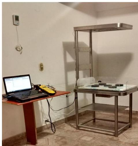
En la imagen anterior vemos físicamente el computador que se encarga de hacer la estimación on line y de generar la señal de control  $U$ , además del patrón de medida para verificar la precisión de los datos y la planta física de la cuna de color radiante.
