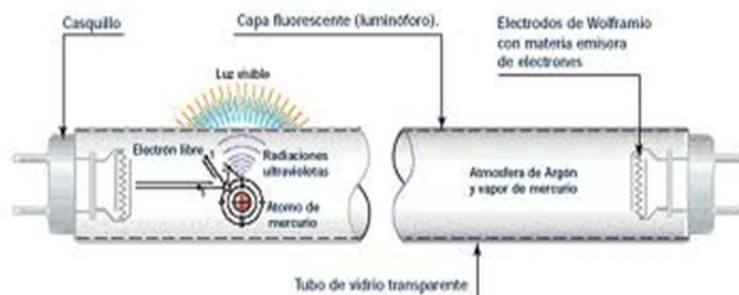
Figura 9 Esquema de una lámpara fluorescente.
