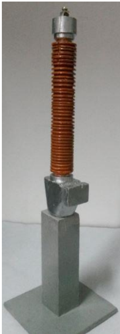
Figura 16. Transformador de potencial del módulo didáctico.
