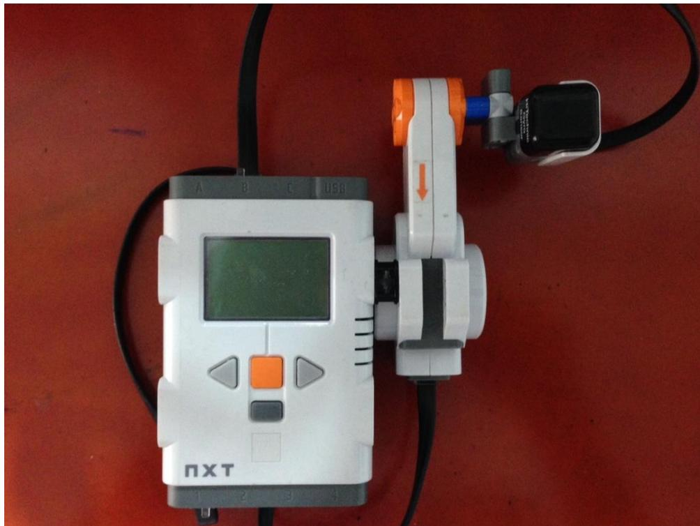
Figura 5.12 Planta para control de ángulo construida con NXT
