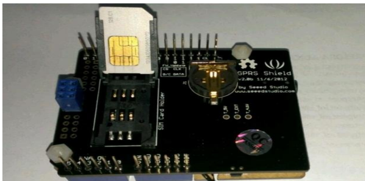
Figura 35. Ubicación de la tarjeta sim en la ranura
