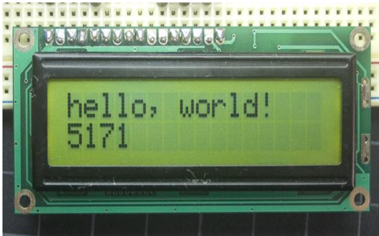
Figura 15. LCD 2x16 con el Standard HITACHI HD44780
