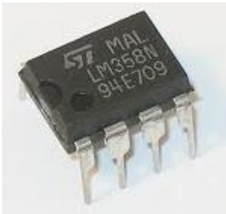
Figura 25. Encapsulado de IC LM358N
