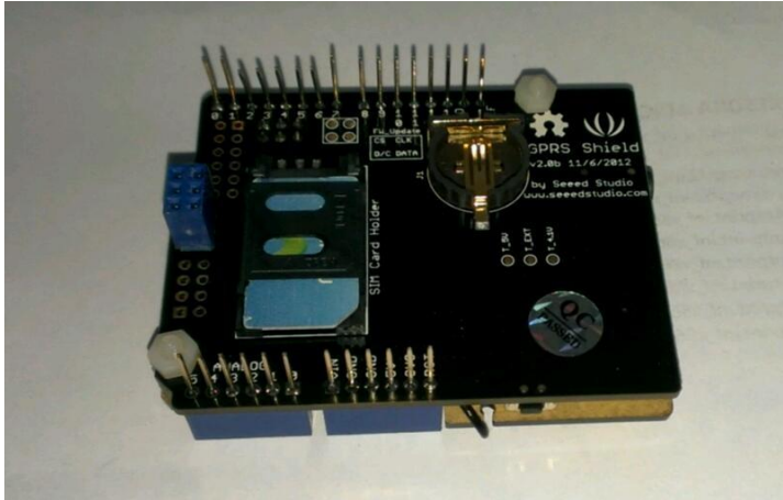
Figura 36. Ubicación de la tarjeta sim de forma correcta
