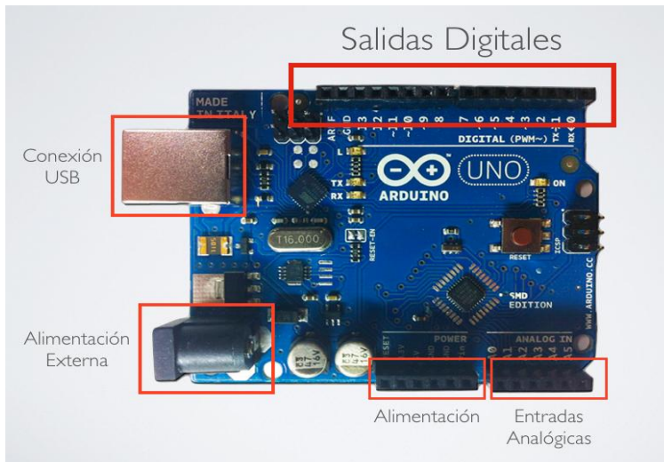
Figura 4. Descripción Arduino (Power, I/O Ports)
