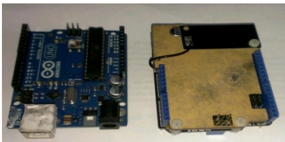
Figura 33. Arduino uno y módulo de trasmisión GSM/GPRS
