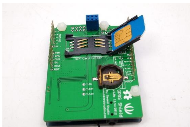
Figura 8. Módulo de transmisión SIMM900 V2.0 visto desde la parte posterior
