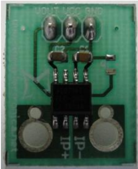
Figura 19. Tarjeta sensor de corriente ACS20A
