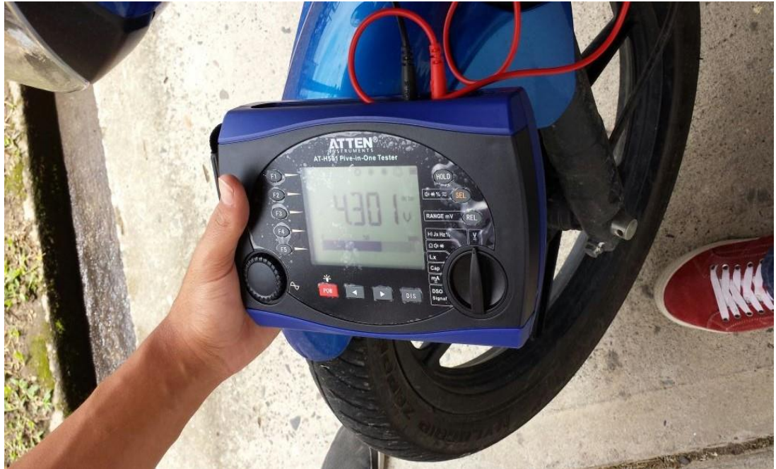
Figura 19: Sensor de rapidez (efecto hall) nibble bajo
