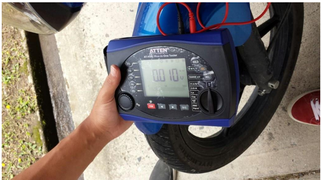
Figura 19: Sensor de rapidez (efecto hall) nibble bajo
