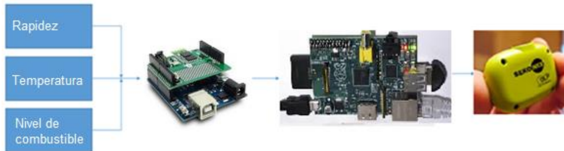
Figura 12: Diagrama de bloques interfaz HUD
