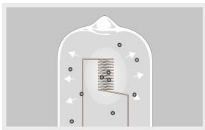
Figura 10. Secuencia del proceso del ciclo del halógeno
