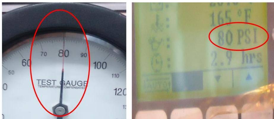
**Figura 29. Resultados prueba sensor presión**
