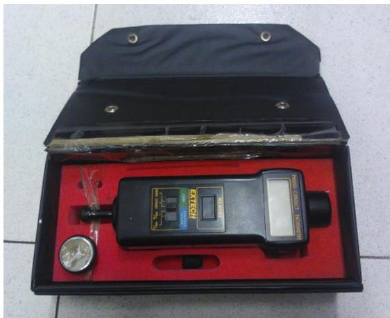
Figura 43. Tacómetro patrón
