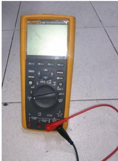
**Figura 45. Multímetro patrón**
