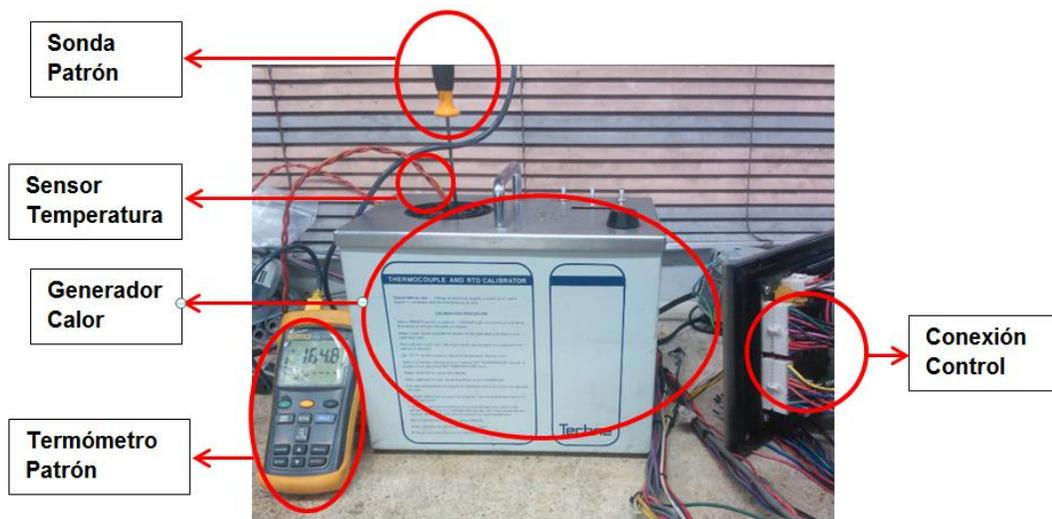
**Figura 37. Prueba con termómetro y sonda patrón**
