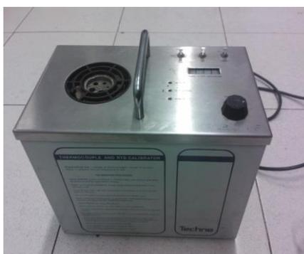
**Figura 36. Banco generador de calor**
