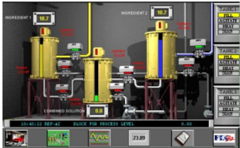
Figura 13. Prototipo de sistema SCADA
