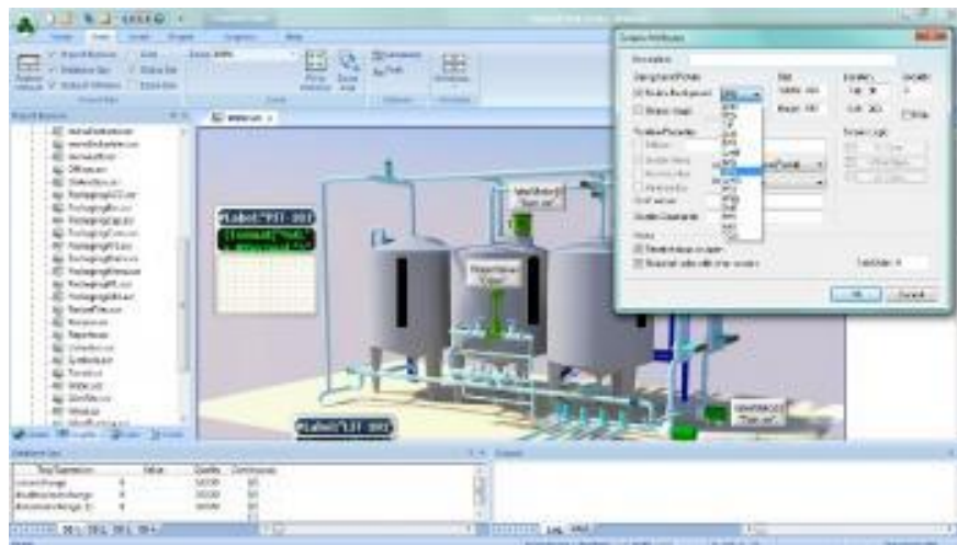
Figura 16: Simulación de tanques InduSoft Web Studio
