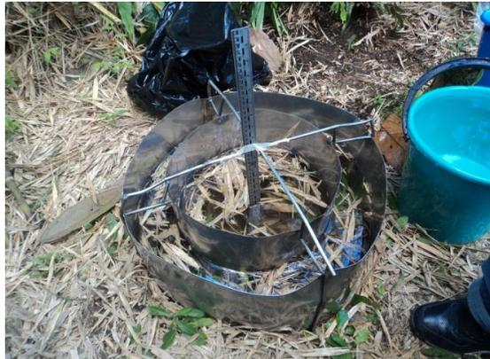
Figura 44. Prueba de infiltración en campo
