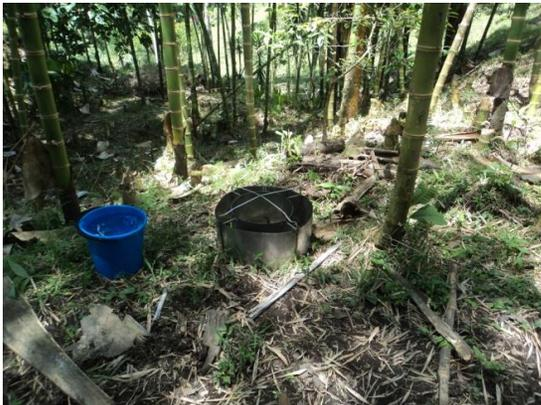
Figura 43. Técnica de infiltrómetros dobles
