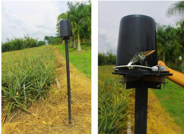
Figura 14. Pluviómetro instalado zona de estudio
