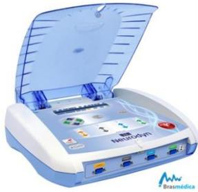
Especificaciones: unidad de electroterapia, con siete tipos de corrientes: Rusa, Aussie, Galvánica, TENS, FES, Interferencial y Microcorrientes con 4 canales de salida y 8 electrodos.
