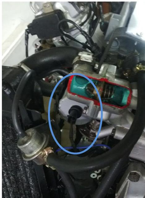
Figura 20. Sensor MAP instalado en el múltiple de admisión
