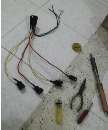
Figura 22. Conexión de los inyectores hacia el ramal
