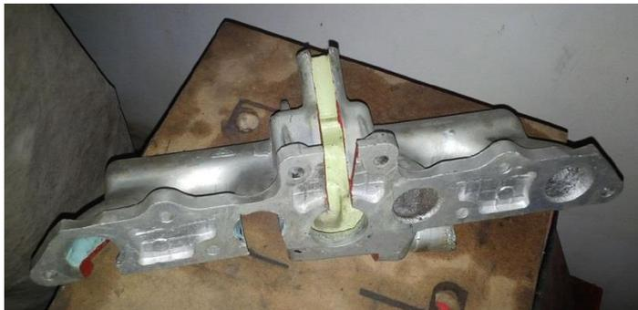
Figura 17. Vista inferior de múltiple de admisión a carburador.
