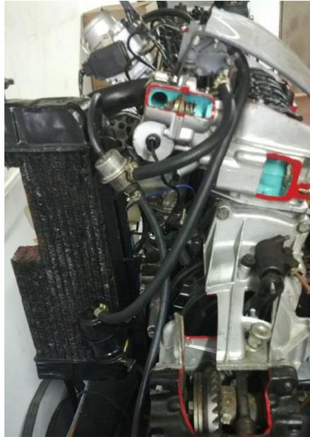
Figura 25. Sistema de alimentación de combustible.
