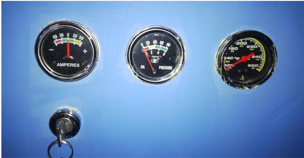
Figura 8. Sistema de instrumentación y control, de derecha a izquierda, carga de batería, ignición de motor, presión de aceite y temperatura de refrigerante de motor.
