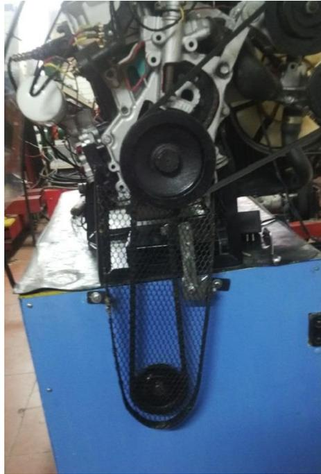
Figura 16. Guarda de la cadencia con tensor instalados en el banco didáctico del motor.
