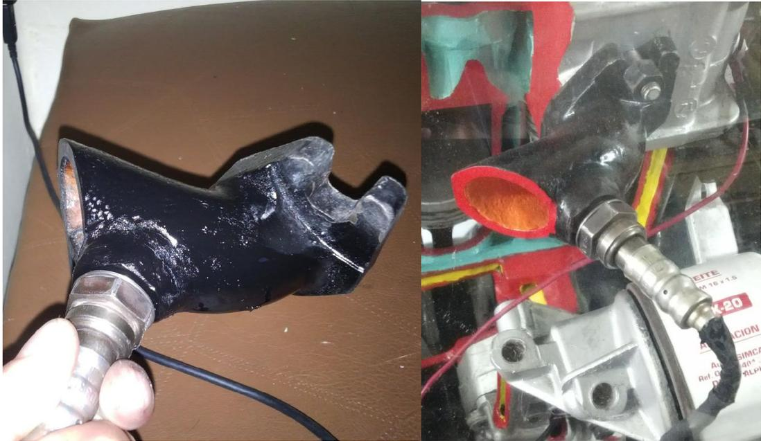
Figura 21. Instalación de sonda lambda en múltiple de escape.
