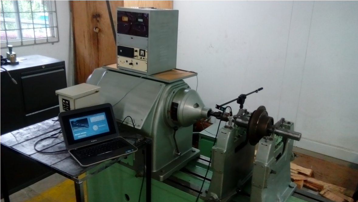
Figura 33. Balanceadora dinámica con sistema desarrollado
