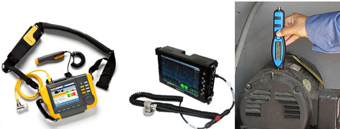
Figura 14. Analizadores portátiles de vibraciones
