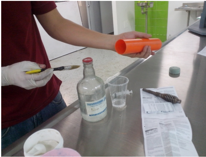
Figura 21: molde para fabricación del compuesto con su desmoldante.
