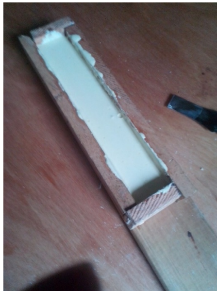
Figura 36: molde para las probetas de tracción.
