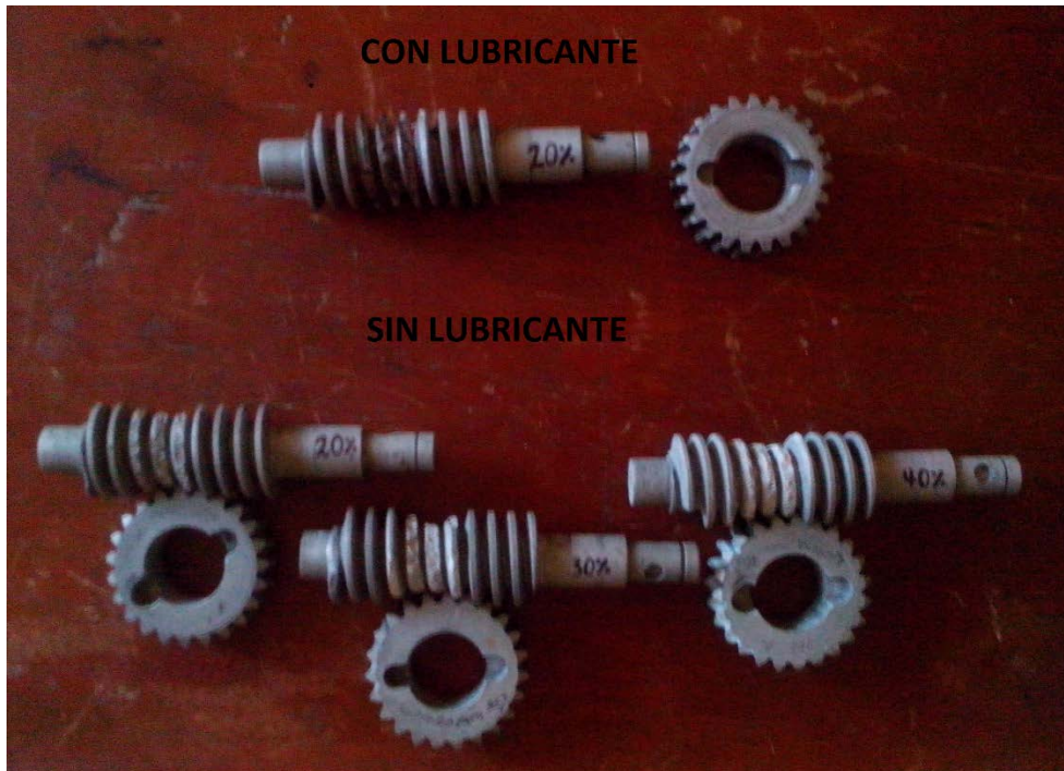
Figura 66: falla de los mecanismos con lubricante y sin lubricante de los compuestos evaluados.
