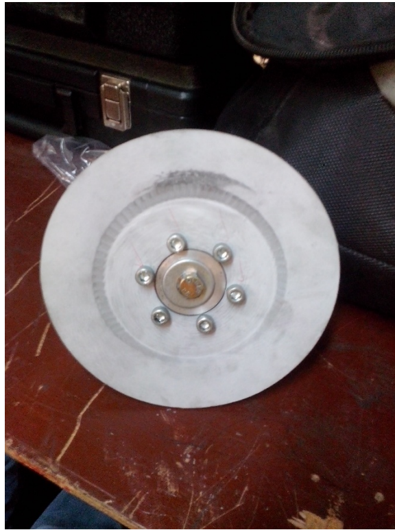
Figura 32: disco del freno de bicicleta en resina R-1248.
