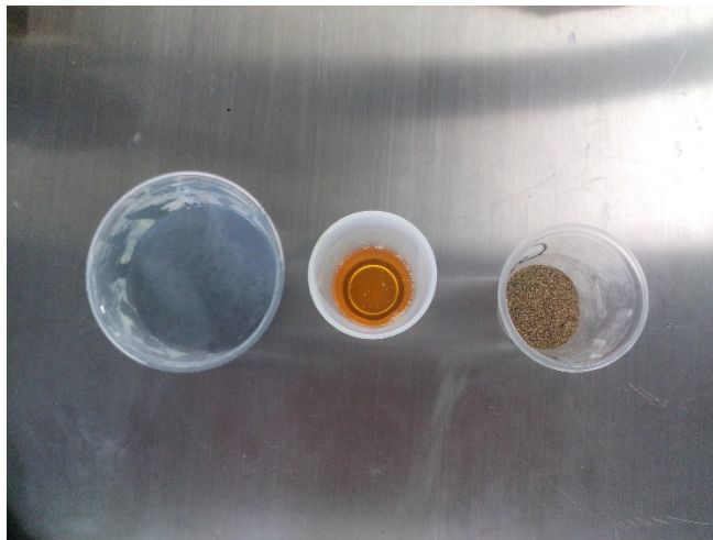
Figura 23: compuestos (resina R-1248, catalizador E-648, viruta de bronce).
