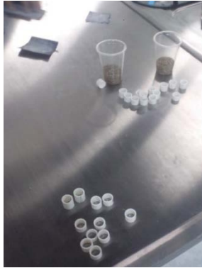
Figura 40: moldes para obtener las probetas de dureza.
