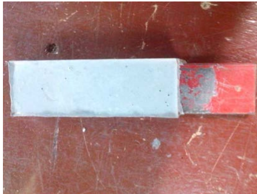
Figura 53: placa resina R-1248 solapada a la placa de acero 1020.
