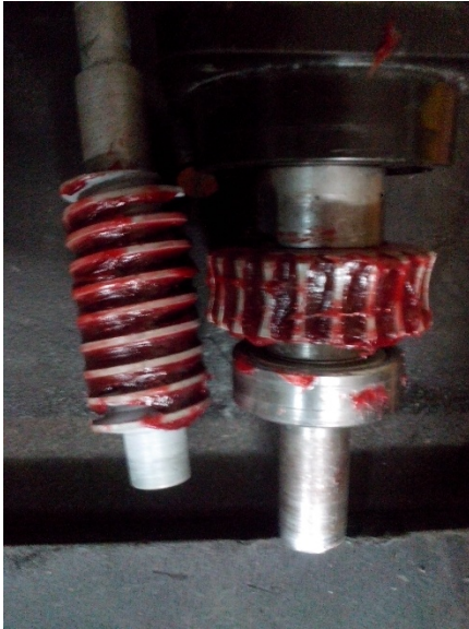
Figura 65: lubricación del mecanismo tornillo sin fin corona.
