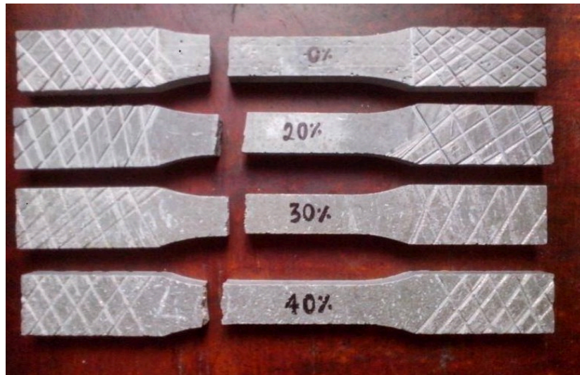
Figura 69: probetas de tracción fracturadas.
