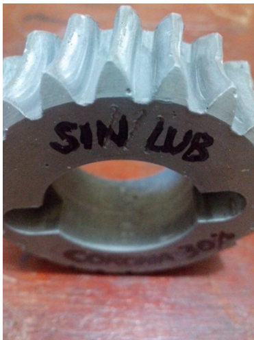
Figura 85: falla de la corona del tornillo de 30% de carga.
