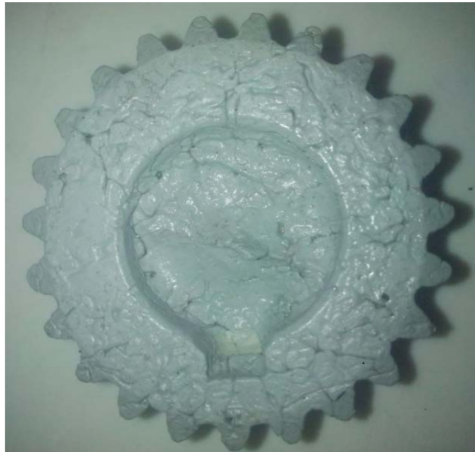
Figura 59: probeta utilizada para la prueba de capacitancia térmica.
