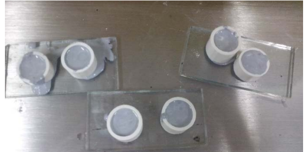
Figura 41: vaciado del compuesto en el molde.
