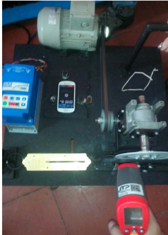
Figura 48: banco de pruebas para el desgaste
