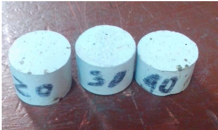
Figura 42: probetas para evaluación de la dureza shore D de los diferentes compuestos fabricados.
