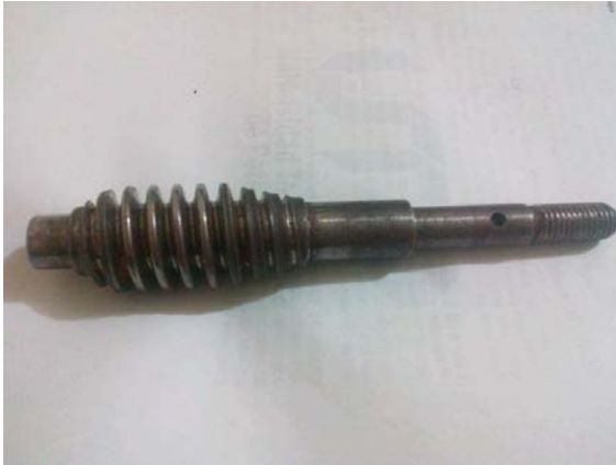
Figura 9: tornillo sin fin del reductor.
