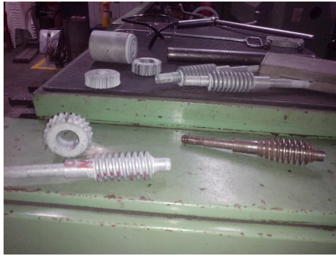
Figura 61: pares de tornillo sin fin-corona con sus respectivos compuestos.
