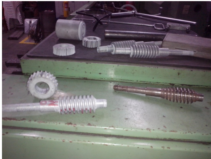
Figura 30: tornillos sin fin y coronas obtenidas en los materiales compuestos.
