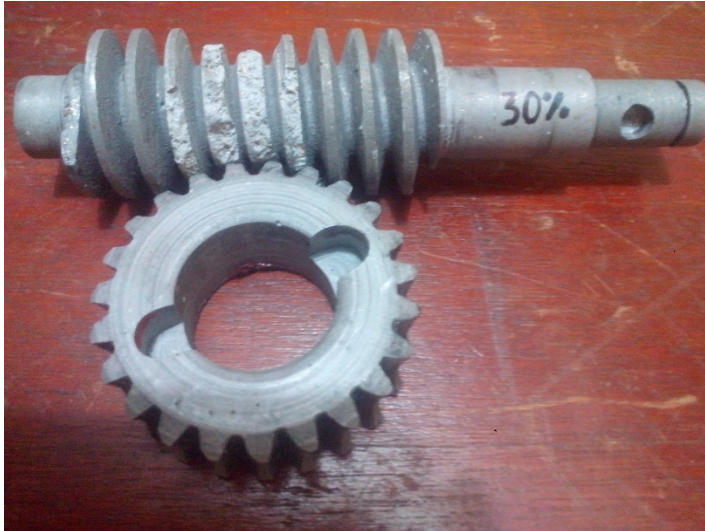
Figura 84: mecanismo de falla del par tornillo sin fin-corona del compuesto de 30% sin lubricante.
