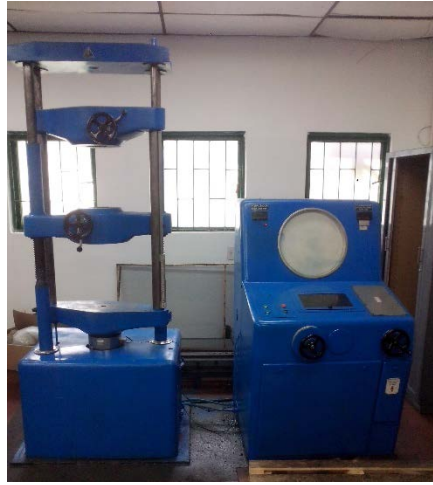
Figura 47: máquina universal para pruebas de resistencia de materiales.
