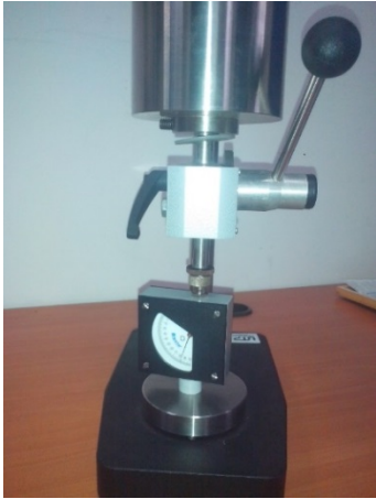
Figura 45: durómetro para pruebas shore D
