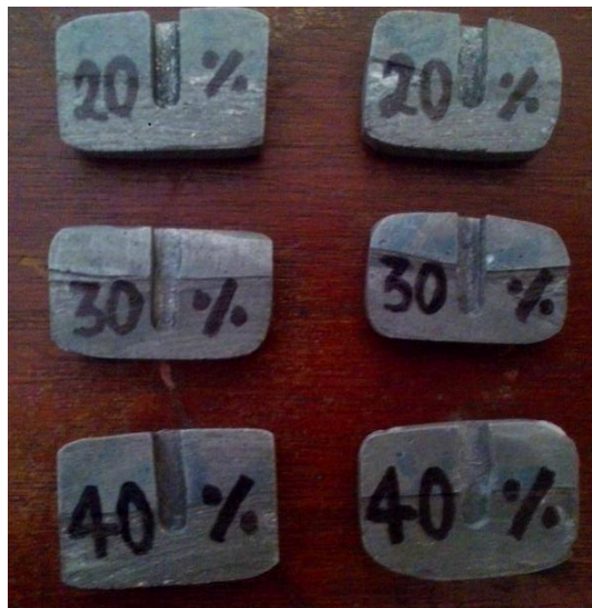
Figura 35: pastillas de freno de disco fabricadas con los diferentes compuestos.
