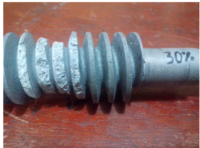
Figura 86: falla del tornillo sin fin del 30% de carga.
