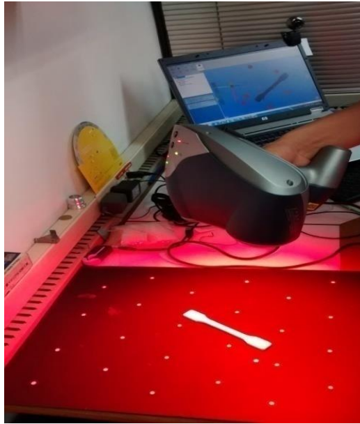
Figura 27. Digitalización de la probeta con el escáner 3D
