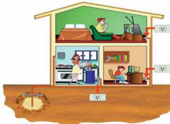
Figura6. Conductor de puesta a tierra
