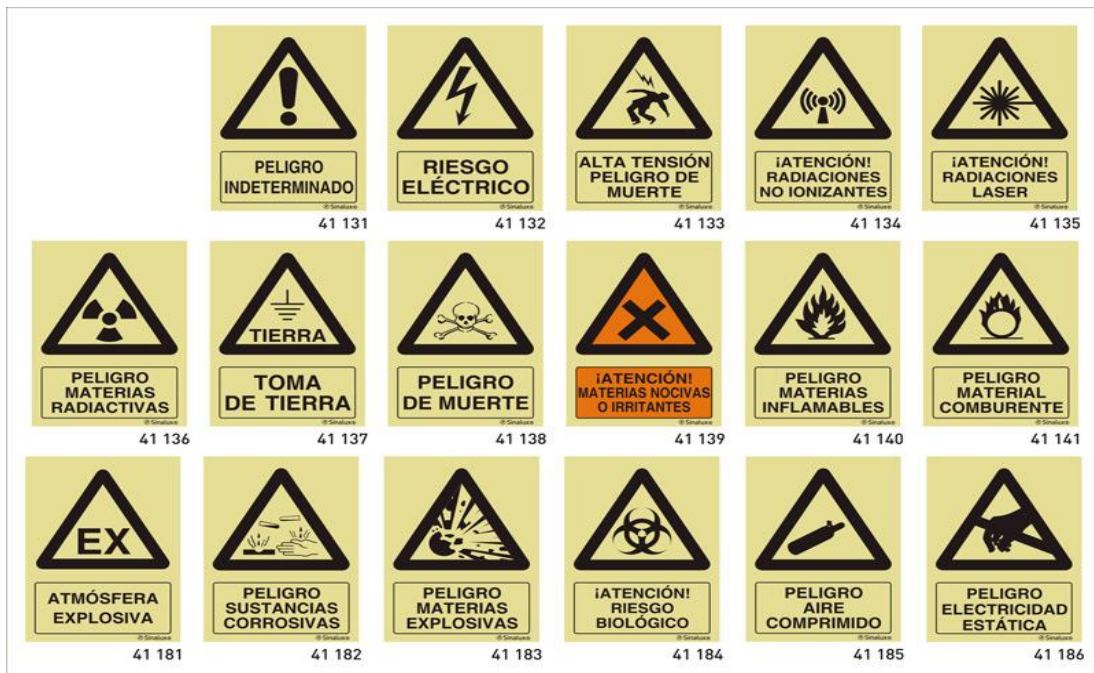
Figura 3. Principales símbolos para señales de seguridad [1].
