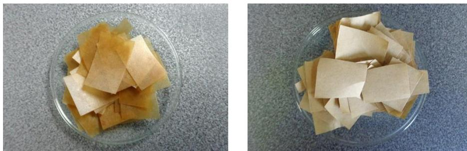
**Figura 20.** Muestra de papel Kraft impregnada de aceite mineral dieléctrico y después de la extracción en Soxhlet para la remoción del aceite (autor).
