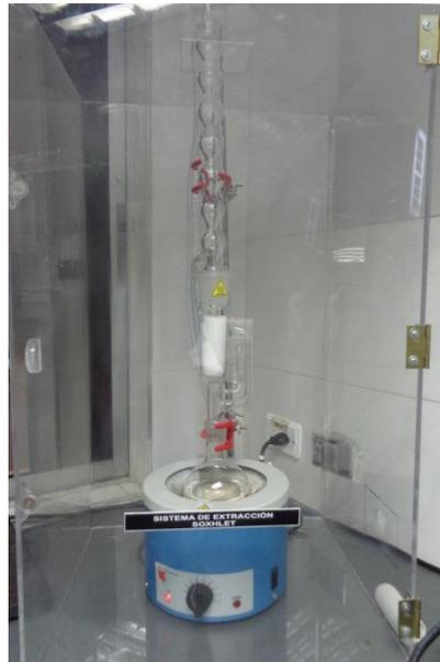
**Figura 15.** Equipo de extracción Soxhlet para realizar el desengrase del papel Kraft (autor).
