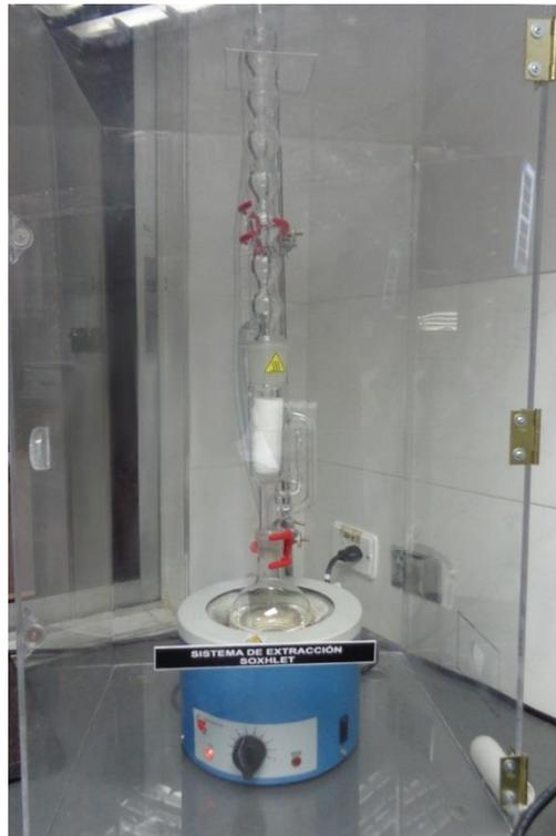
**Sistema de extracción Soxhlet**
