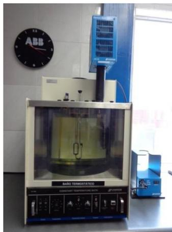
**Figura 14.** Viscosímetro de Ubbelohde y baño termostático (autor).
