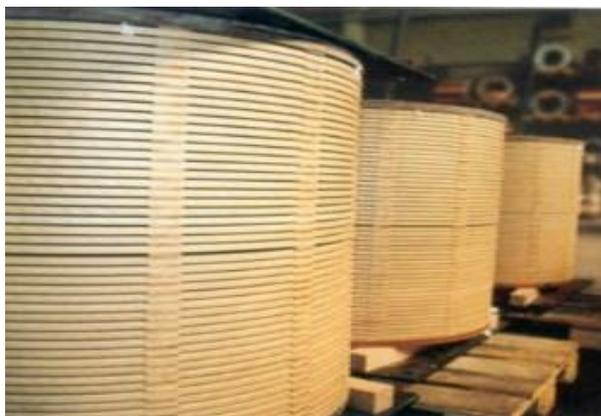
**Figura 1.** Bobinas de un transformador de potencia [13].
