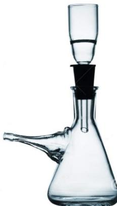
**Figura 16.** Filtro sinterizado acoplado a sistema de vacío (autor).
