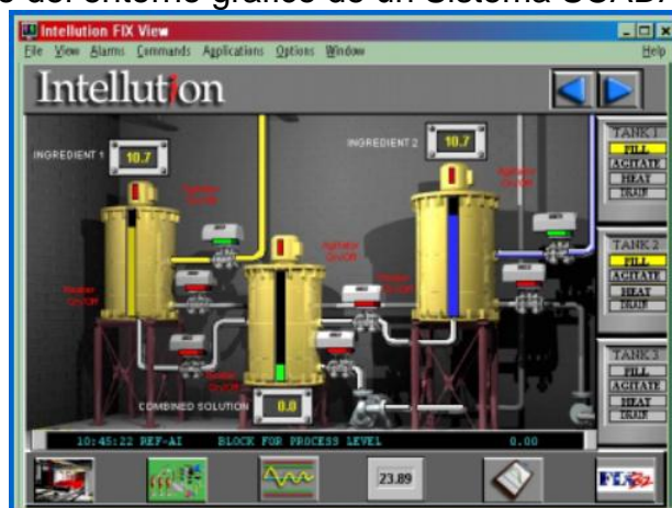
Figura 16. Ejemplo del entorno gráfico de un Sistema SCADA [33]
