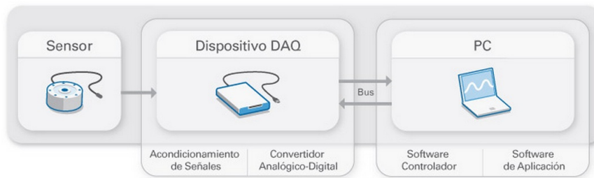
Figura 8: Partes de una DAQ. Tomada de [3]
