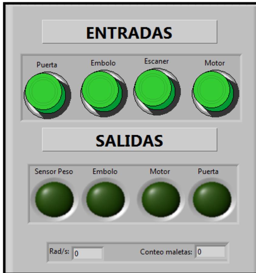
Figura 31: Interfaz de variables globales para modo simulación, sistema banda transportadora
