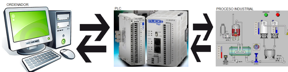
Figura 1: Componentes de automatización
