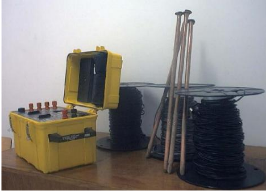
Figura 63 Equipo para la medición de puesta a tierra
