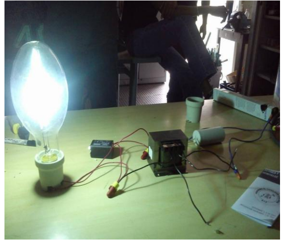
Figura 126 Lámpara 400 W alta presión metalhalide
