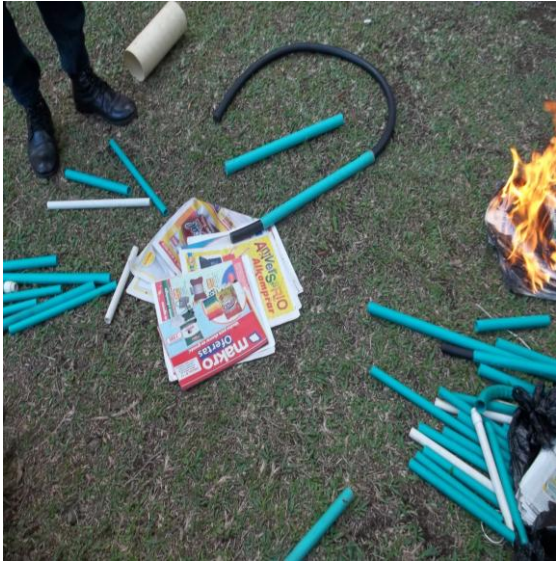
Figura 74 Material utilizado para el doblado de tubería
