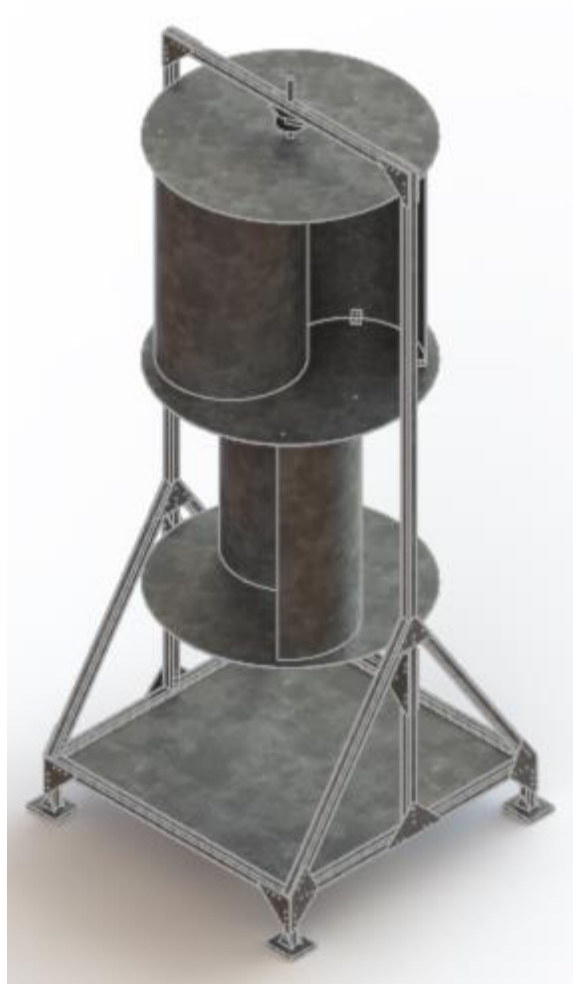
Figura 6.5 Ensamblaje de los componentes del aerogenerador
