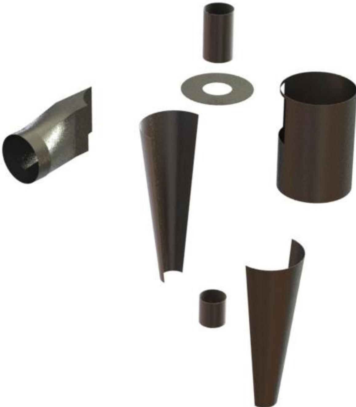
Dentro de las consideraciones que deben hacerse en la construcción del ciclón está en primer lugar la hermeticidad, pues las fugas pueden alterar los patrones de flujo y liberar aire contaminado, en segundo lugar, la integridad geométrica, respetando las formas concebidas en el diseño.
