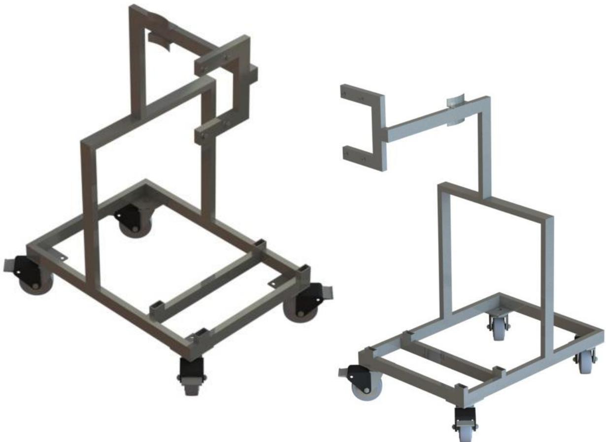
En la base se anclan el ventilador y la caja de filtros, en el brazo superior se anclan el ciclón el brazo aspirador. Obsérvese el detalle de las bridas de sujeción del ciclón y los orificios de anclaje para el brazo.
