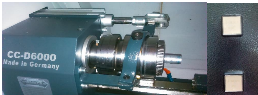
Figura 29. Sujeción de material a maquinar.
