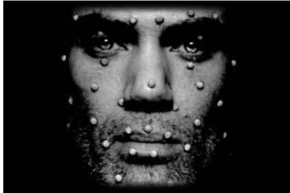
Figura 28. Captura de movimiento de la cara usando indicadores pasivos [59].
