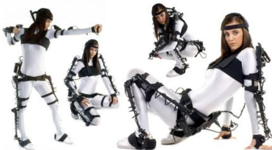
Figura 27. Traje utilizado en captura de movimiento electromecánico [58].
