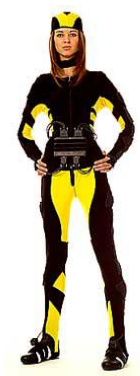
Figura 31. Traje con sensores inerciales y unidad motora [62].
