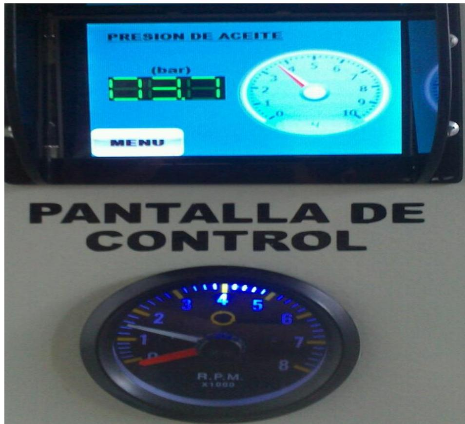
Figura 68: Presión de aceite a 3,7 bar en 1600 RPM.
