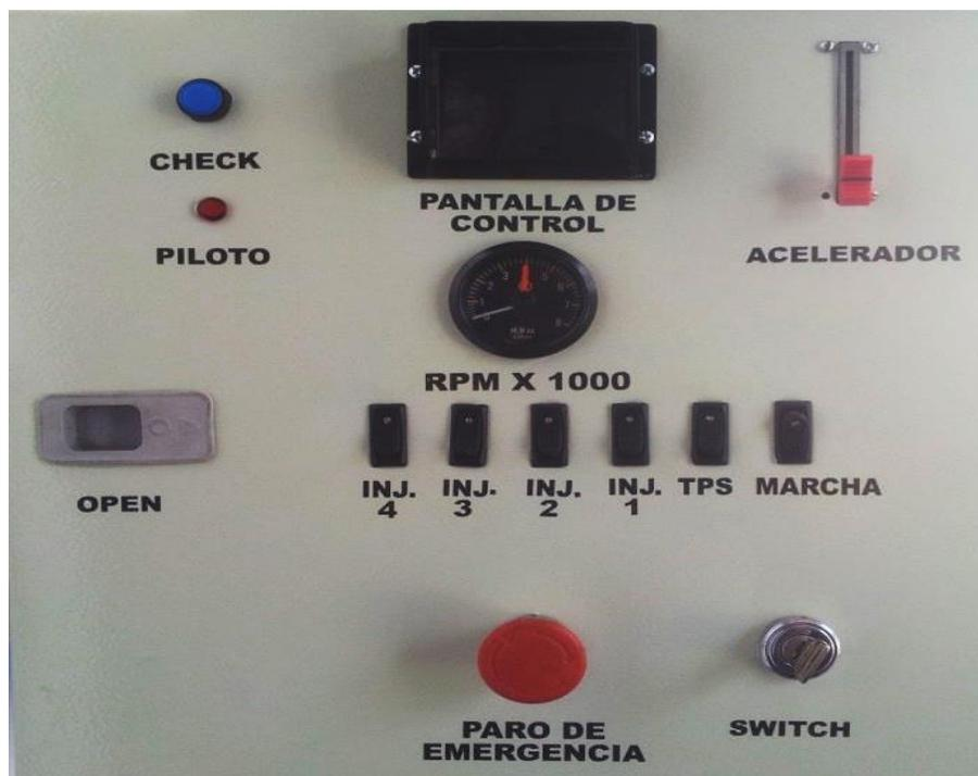
Figura 61: Vista general de los dispositivos electrónicos en el sistema didáctico del motor Nissan Sentra
