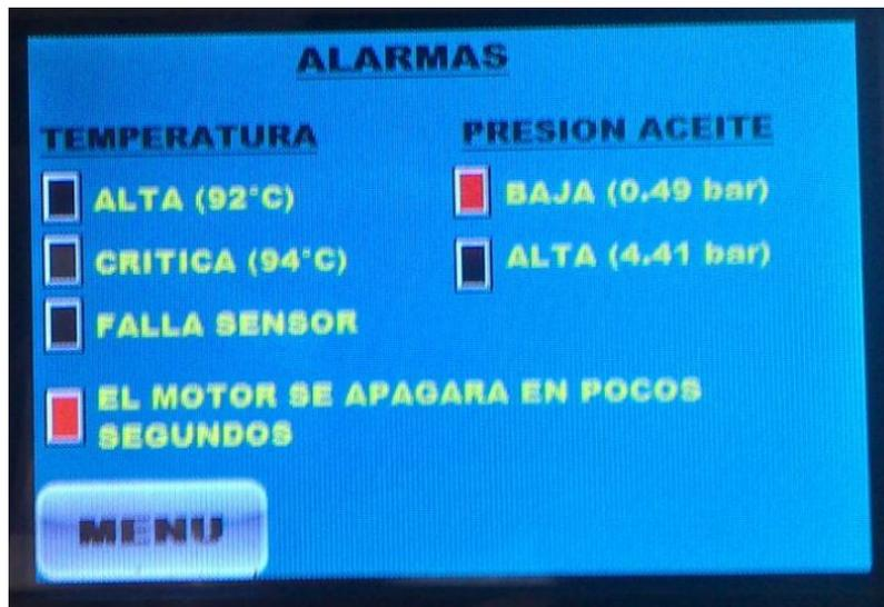
Figura 59: Alarmas de protección del motor, por lubricación o temperatura
