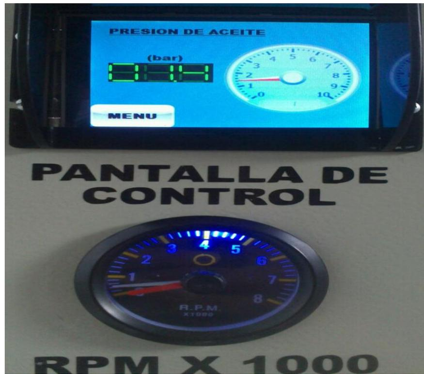
Figura 69: Presión de aceite a un régimen de 650 rpm en 1,4 bar
