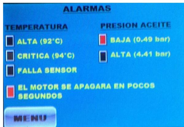
**Figura 9:** Alarmas de protección del motor, por lubricación o temperatura
