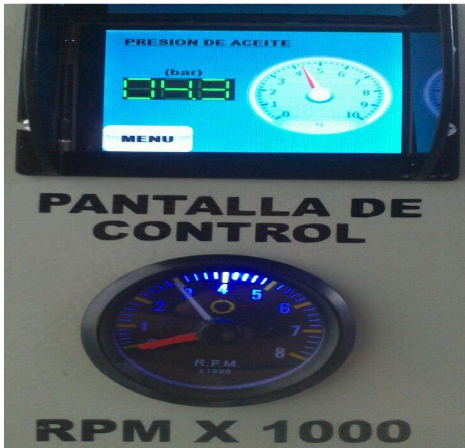
Figura 67: Presión de aceite a 4,3 bar visualizada en la pantalla táctil.
