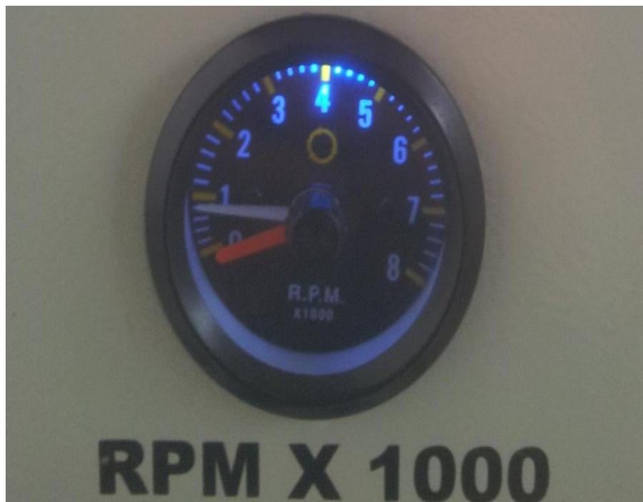
Figura 56: Tacómetro de revoluciones
