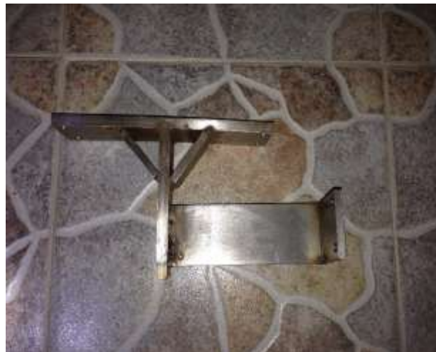
Figura 44. Brazo soporte celda de carga
