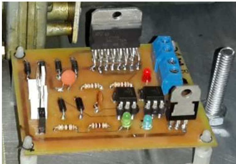
Figura 50. Tarjeta driver motor con sus componentes
