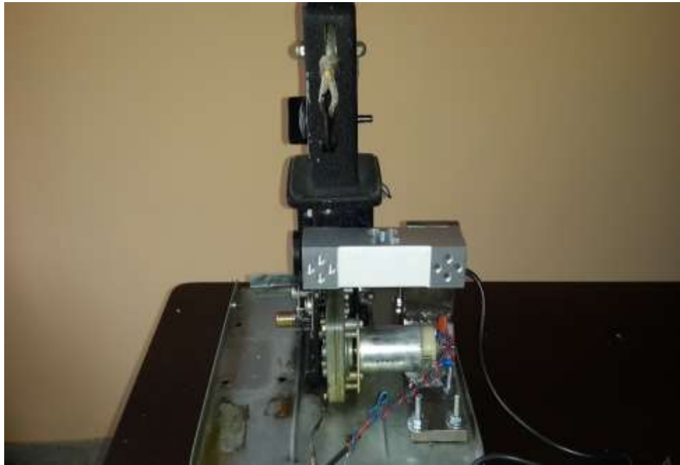
Figura 46. Vista lateral del montaje celda de carga
