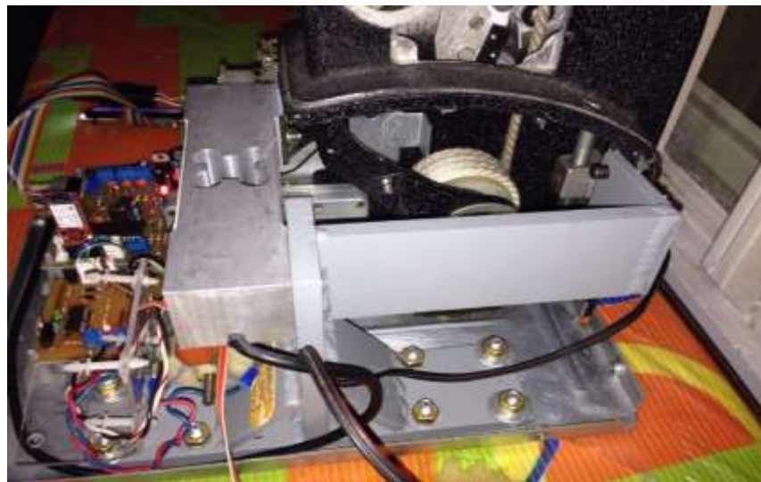
Figura 46. Vista lateral del montaje celda de carga
