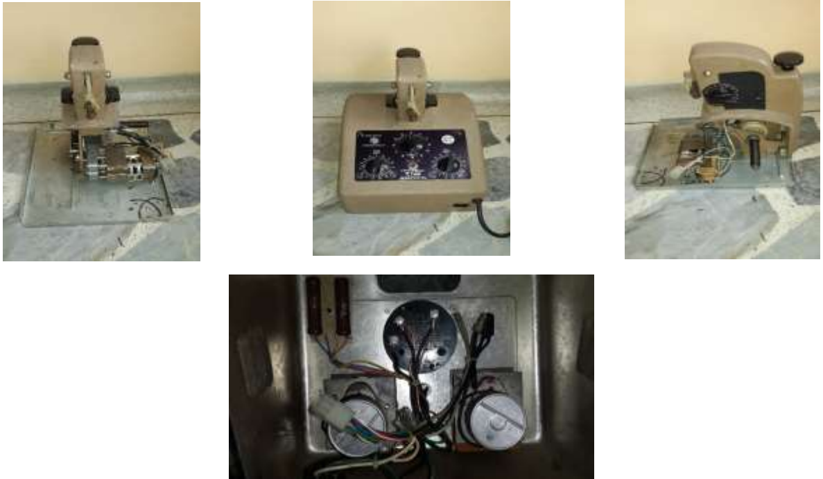
Figura 43. Estado original de la máquina de tracción
