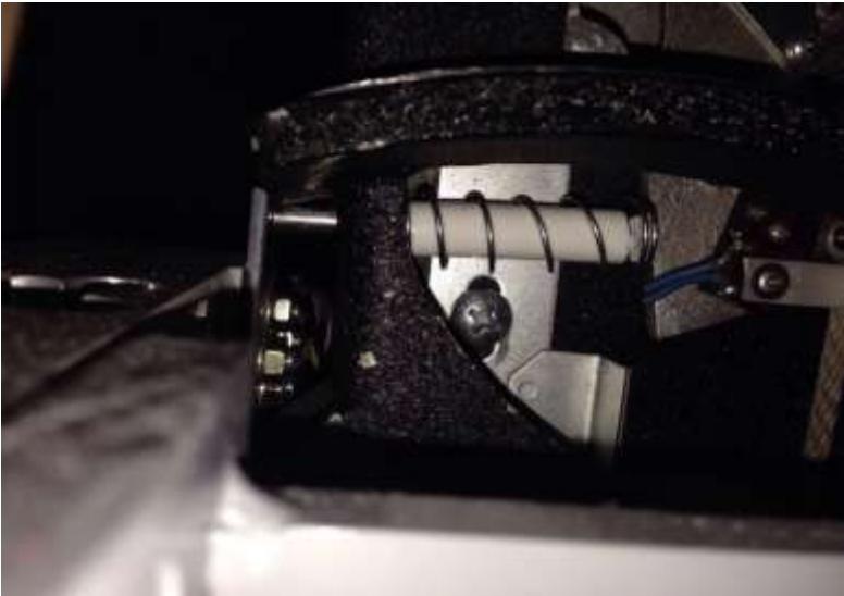
Figura 47. Vista sistema de acoplamiento para transmisión de fuerza a la celda de carga
