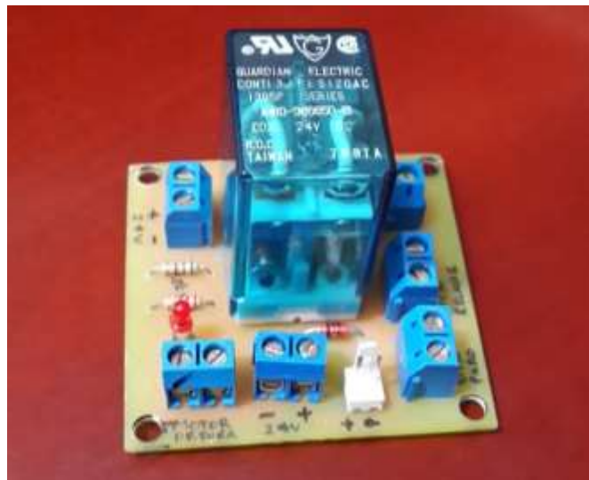
Figura 55. Tarjeta de emergencia con sus componentes
