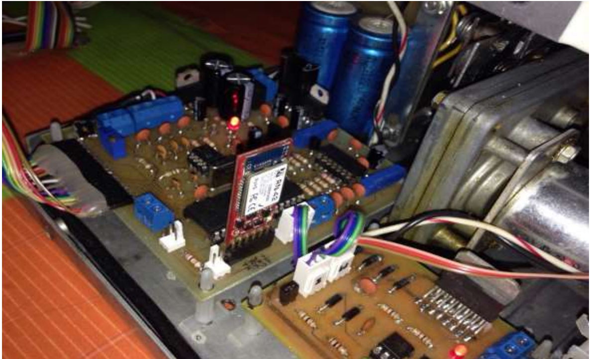
Figura 56. Montaje tarjeta de control, Bluetooth y tarjeta driver motor
