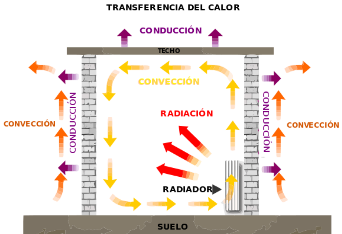
Figura 6. Diferentes mecanismos de transferencia de calor.
