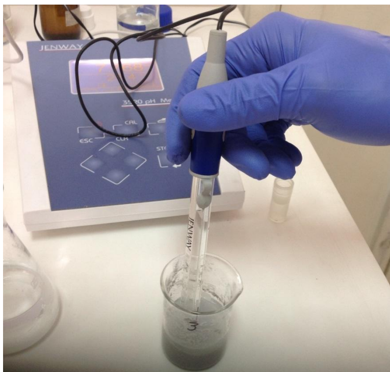
Figura 5. Imagen de la toma de pH para una de las muestras de lodo. (Ref.: Propia, 2013)
