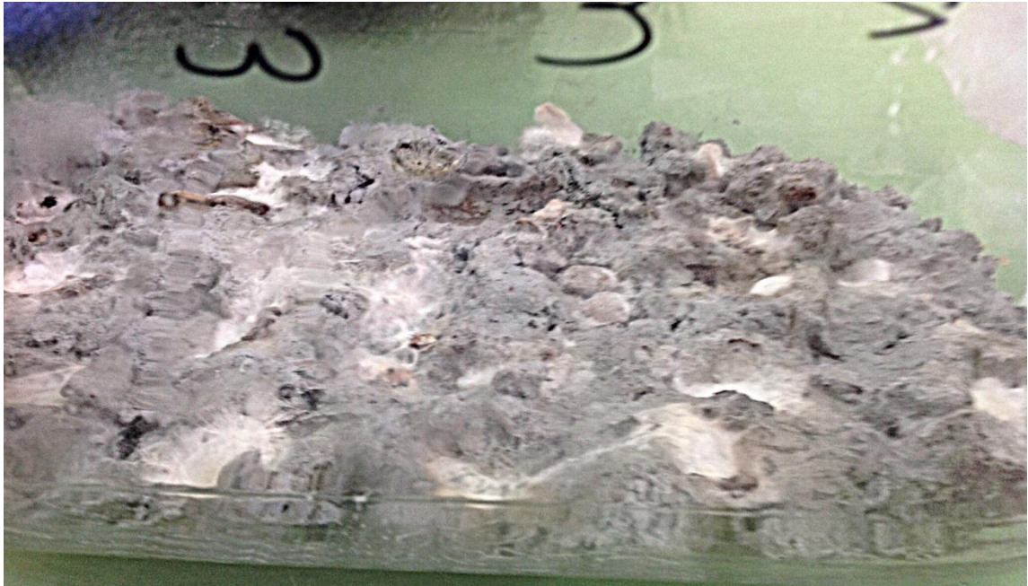
Figura 10. Lodo inoculado con 20 frijoles con G.lucidum en la semana 3, por triplicado. Obsérvese presencia del micelio (zonas blancas) en mayor cantidad que en la imagen anterior. (Ref.: Propia)
