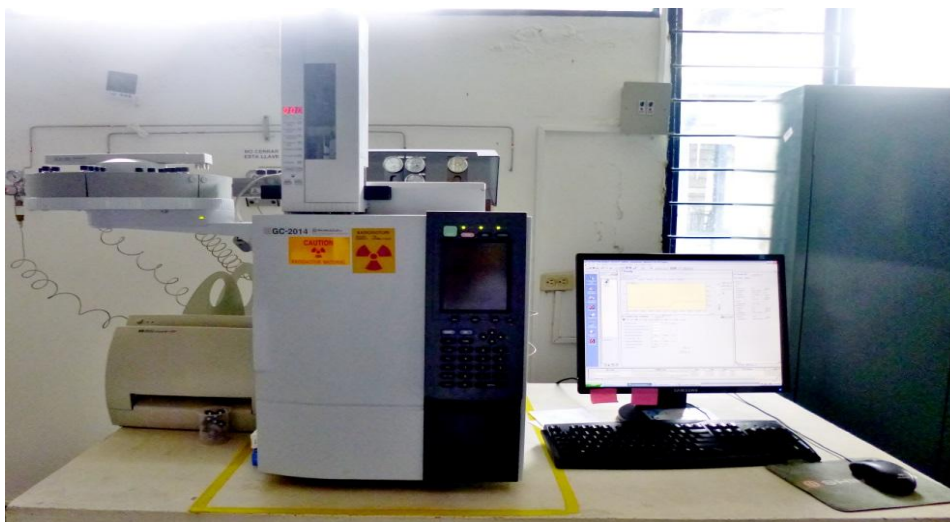
Foto 1. Cromatografo de gases de la Universidad Tecnológica de Pereira, utilizado para el análisis de los PCPs. Por Valeria Duque
