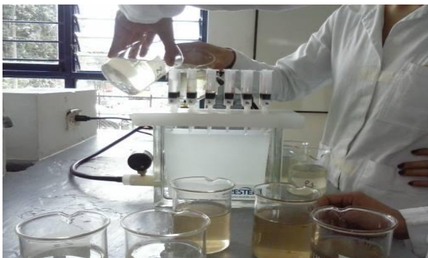
Foto 8. Equipo de Extracción en fase solida con velocidad de flujo 10ml/min. Por Sandra Rincón
