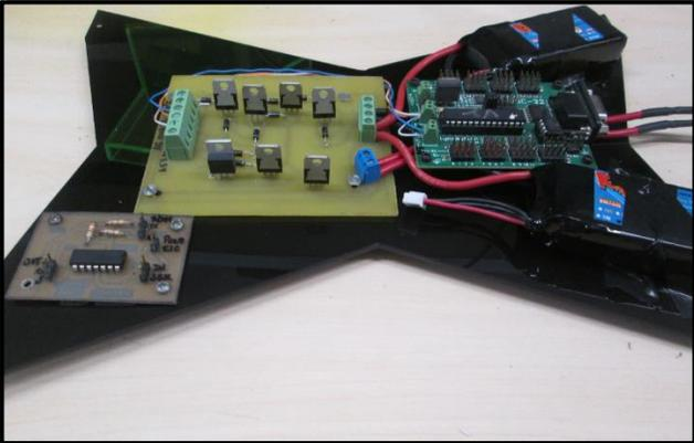
**Figura 84:** Base del brazo terminada vista inferior.
