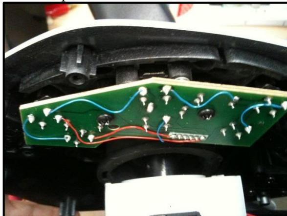
**Figura 51:** Identificación e independización de cada uno de los potenciómetros.
