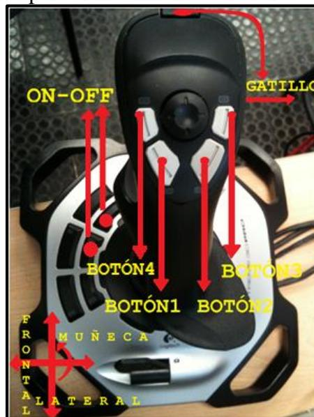
Cada una de estas teclas debe controlar un servomotor del brazo, entonces al presionarse una de estas y accionar la palanca ya sea hacia adelante, atrás o ejecutarse un movimiento de muñeca el servomotor se desplaza a esta posición, para esto es necesario hacer un manejo especial tanto con las señales análogas como digitales, así como se muestra a continuación.
