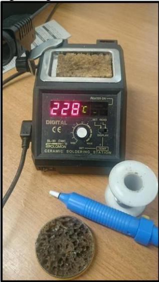
**Figura 73:** Proceso de soldadura de los elementos al circuito impreso.
