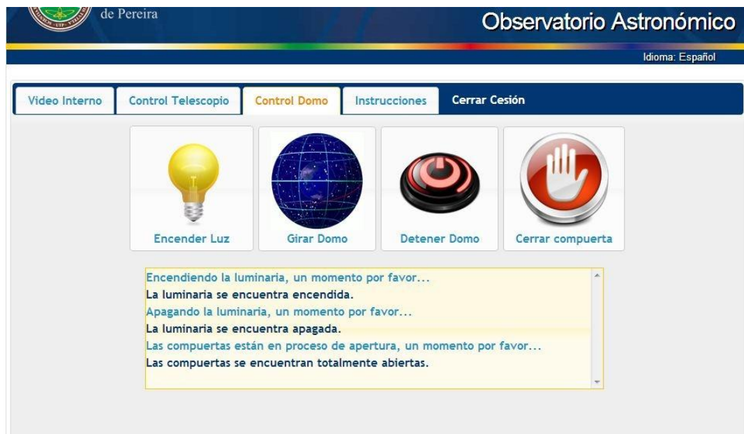
Figura 186. Proceso de apertura de compuertas del domo mediante control web.
