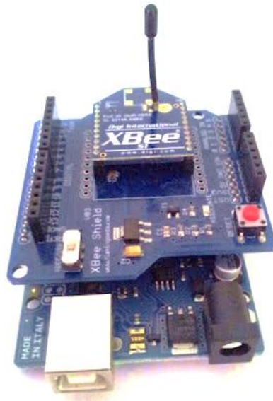
Figura 16. Módulo Arduino Uno con Shield Xbee y Xbee integrado.
