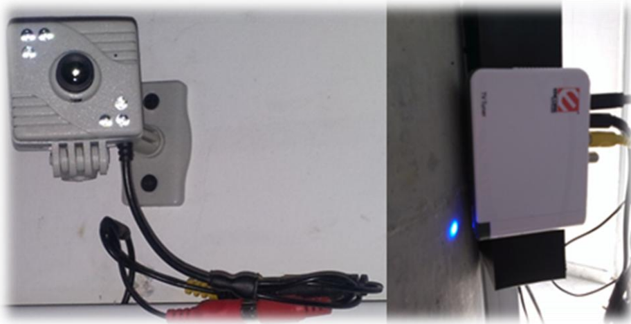
Figura 50. Cámara de seguridad y tarjeta importadora con conexión RCA.
