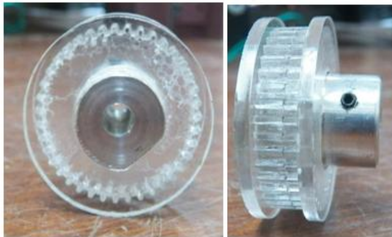
Figura 17. Acople motor rueda dentada.
